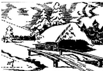
Рис. 6 Солнечные лучи греют наклонную крышу сильнее, чем горизонтальную поверхность земли
