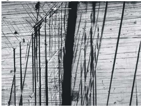
Рис. 6.1. Участок зарождения трещины (отмечен стрелкой) в зоне взаимодействия двойников у поверхности образца.
