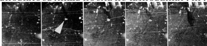
РИС. 10.17. ЗАРОЖДЕНИЕ И ИСЧЕЗНОВЕНИЕ УПРУГОГО ДВОЙНИКА В КОНЧИКЕ СКОЛА В КРИСТАЛЛАХ КАЛЬЦИТА. ДВОЙНИК ОТМЕЧЕН СТРЕЛКОЙ
