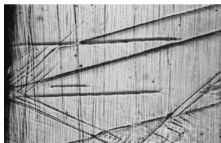
Рис. 6.7. Образование вторичных двойников (показаны стрелкой) с поверхности образца; T = 203 \text{ K} \square 30 мкм
