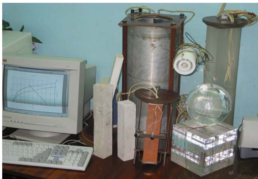
Рис. 5.5.2. Просмотр файла на ЭВМ при определении температуропроводности красного кирпича в графическом виде программы Excel
