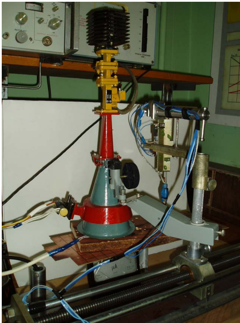
Рис. 5.9. Приемно-передающая апертура с клистронным СВЧ ГУН и устройством снятия ДН и измерения поля рассеяния
