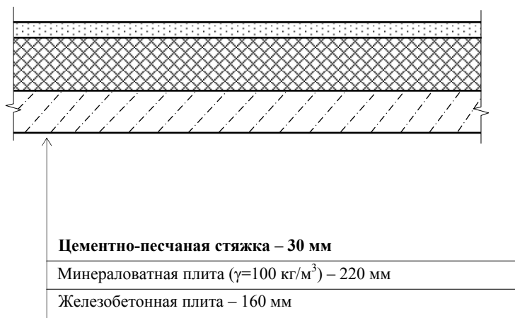
Рис. 6 Схема чердачного перекрытия
