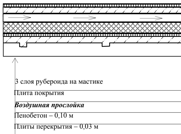
Рис. 22 Схема совмещенного вентилируемого покрытия
