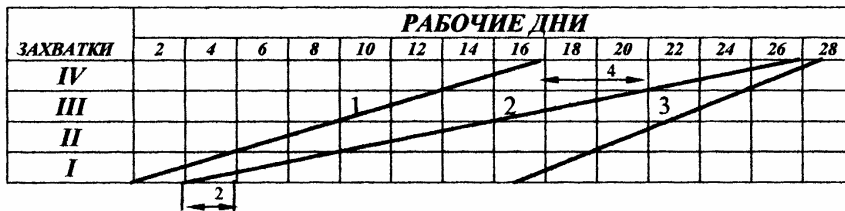
Рис. 4.17 Циклограмма разноритмичного строительного потока с совмещением процессов
