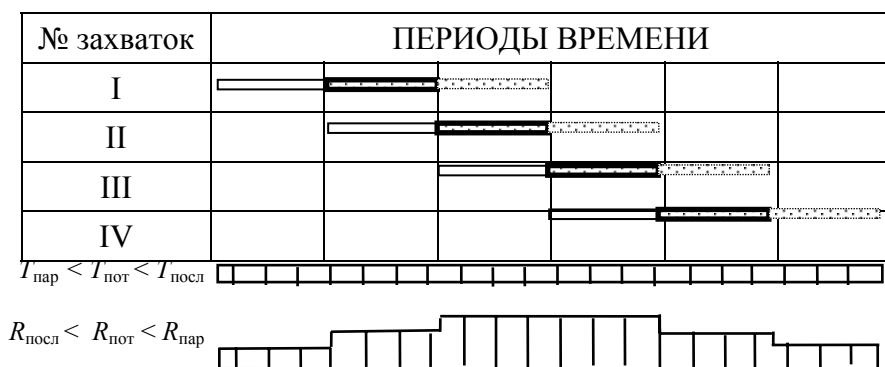
Рис. 1.3 График строительства объектов поточным методом
