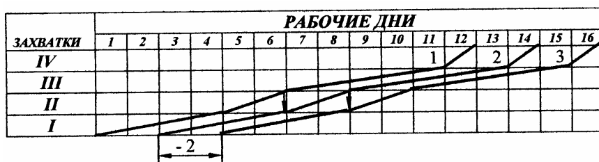
Рис. 4.20 Матрица расчета параметров неритмичного потока с однородным изменением ритма с совмещением процессов
