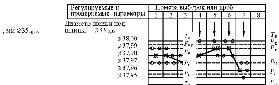
Рис. 3.1 Пример заполнения контрольной карты статистического регулирования методом медиан и индивидуальных значений
