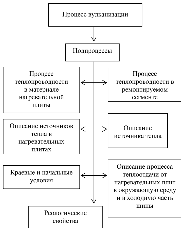
Рис. 4 Структура математического описания процесса вулканизации местного ремонта шин
